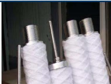
应用于电厂凝结水处理系统，粉末树脂覆盖过滤器内部安装滤元，滤元表面可以用纤维粉和阴阳树脂粉铺膜以达到过滤和除盐目的，当过滤器进出口的压差达到设定上限，过滤器处于失效状态，将对过滤器进行爆膜和反洗，然后进行铺膜后再投入运行。
